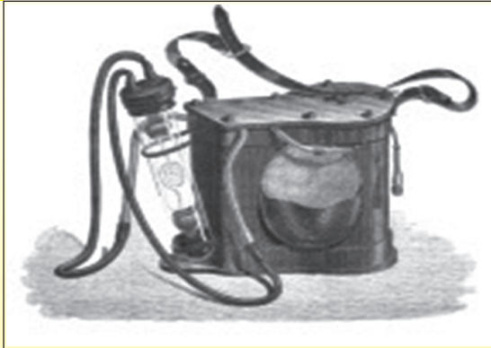
1862年Dumas et Benoit的电矿工灯
