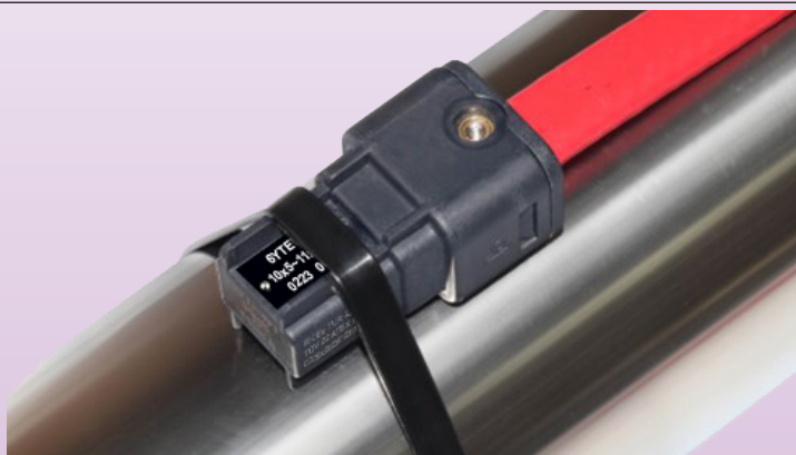
电缆插入拧紧并安装在管道上
